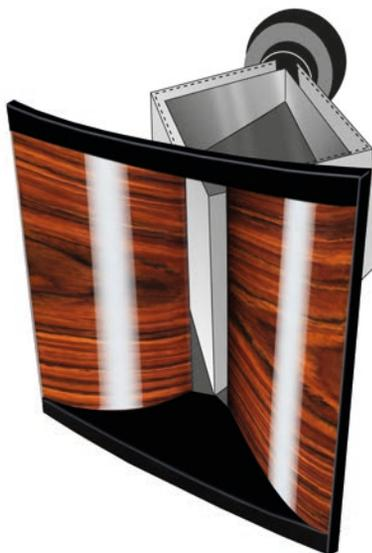
Schematische Darstellung des Fraunhofer-Strahlers
