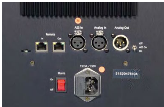
Die Netzwerkbuchsen dienen zur Konfiguration der optionalen Raumanpassung oder zum Anschluss der B&M-eigenen Vorstufe.
