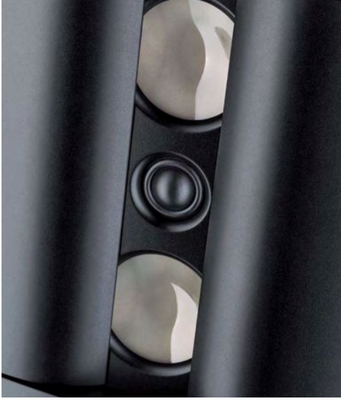
Der Hochtöner setzt bereits bei ungewöhnlich tiefen 1,5 kHz ein. Dadurch erscheinen die beiden Mitteltöner wie ein großer Treiber.
